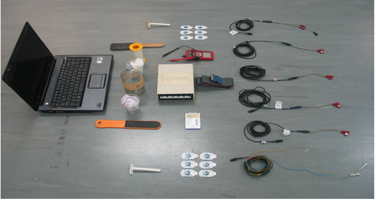
Şekil 4: Modern bir sEMG kayıt sistemi. En solda veri almak için kullanılan dizüstü bilgisayar; sağındaki sırada cilt temizlemede kullanılan sulandırılmış alkol, pamuk, zımparalar ve jiletler; sonraki sırada Ag/AgCL elektrotlar, kutulanmış DAQ kartı (analog EMG sinyallerini dijitale çeviren devre kartı) ve dijital sinyalleri bilgisayara aktaran kablolar, elektrotlar arası direnci DC olarak ölçmede kullanılan AVometre (Amper, Ohm ve Voltaj ölçer); en sağdaki sırada ise 5 adet sEMG sensörü ve 1 adet olay ( Event ) kaydedici kablo bulunmaktadır. Üzerinde patolojik organizma ve zararlı kimyasal madde bulunmadığından emin olunan jilet, pamuk ve zımpara her denek için ayrı olarak kullanılmalıdır. 5 adet sEMG sensörünün üzerinde karışıklık olmaması için etiketler olmalıdır. Olay kaydedici kablo, hareketlerin belli bir anını (örneğin ayağın yere değmesi veya yerden kalkması, okçular için clicker 'ın düşmesi gibi) sEMG ile eş
