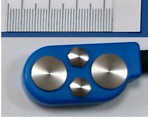
Şekil 9: Üç girişi olan double differential sensör. Ortadaki altıgen metaller toprak elektrotu olup dairesel metaller pozitif ve negatif elektrotlara karşılık gelmektedir.
