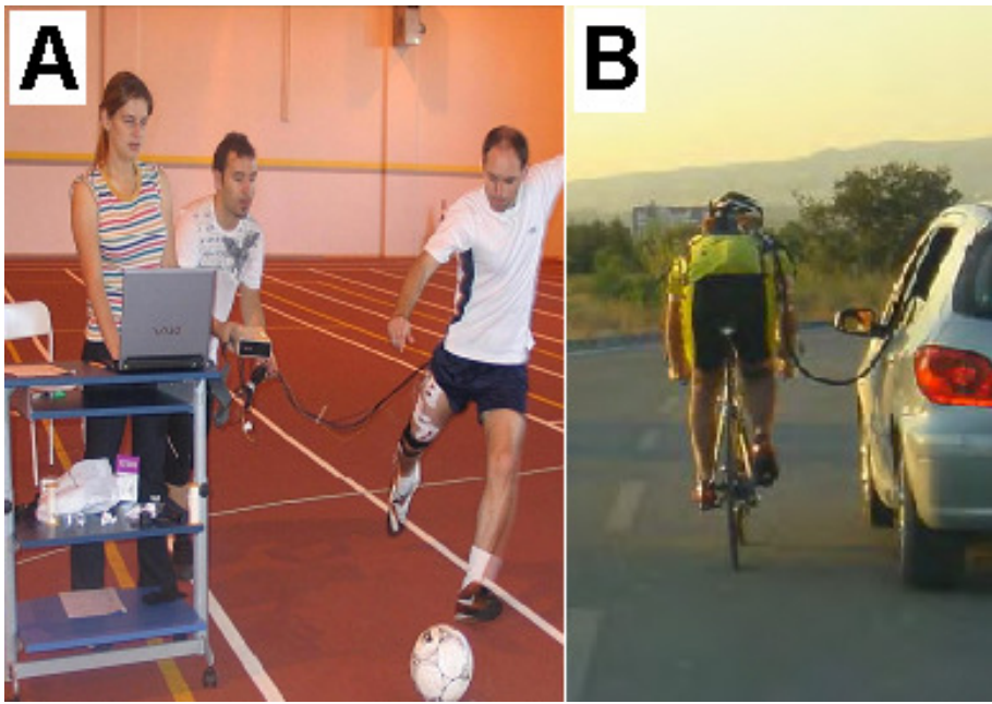
Şekil 5: EMG kaydı yapılan iki farklı çalışma düzeneğine ait örnekler: topa vuruş (A) ve bisiklet sürüşü sırasında (B) sEMG kaydı alınıyor. Sırasıyla Ali Onur Cerrah ve Dr. Pınar Arpınar-Avşar'ın yüksek lisans ve doktora tezlerinden izinle kullanılmıştır.
