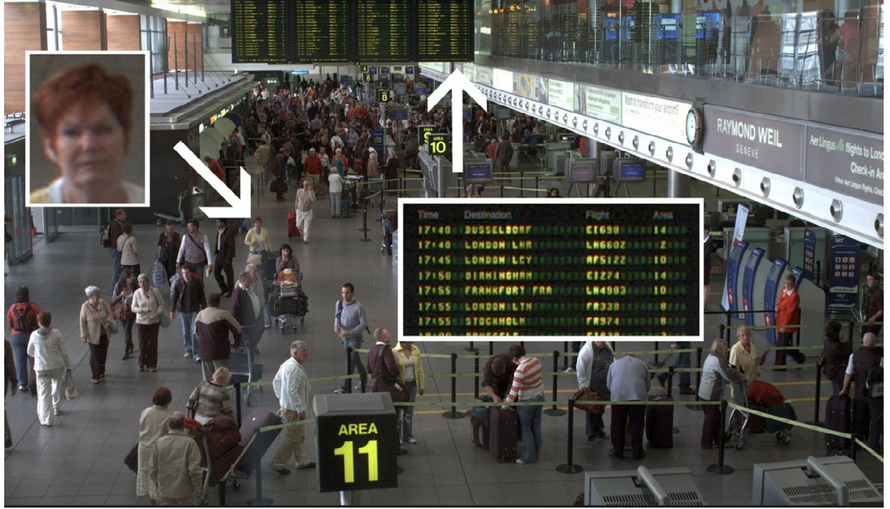
Şekil 1. 16 Mega-piksel çözünürlükte resim karesi; sayfaya sığması için küçültülmüş olup gerçek ayrıntı düzeyinden örnekler beyaz dikdörtgenler içerisinde gösterilmiştir (www.avigilon.com, 2010)[15].
