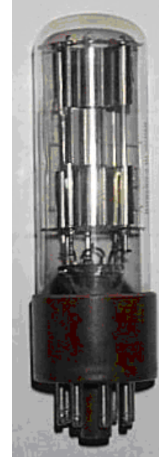
Şekil-24. Ferranti GRD7 diyot lambasının şematik geometrisi ve resmi.
