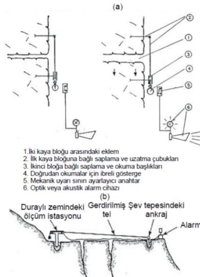
(a) Çatlaklar boyunca gelişen hareketi ölçen ve uyarı sistemine de bağlanabilen yüzey ekstansometreleri (fisürometre; Interfels, 1981) ve (b) şev tepesine yerleştirilmiş yüzey ekstansometresi (Wyllie ve Munn, 1978).
