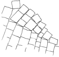
Şekil 2.8. Blok tipi devrilme (Hoek ve Bray, 1977).
