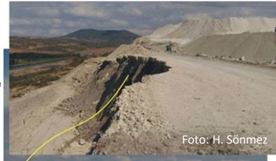
Şekil 2.13. (a) İleri derecede eklemli kaya kütlelerinde ve (b) ayrılmış kayalarda dairesel kayma.
