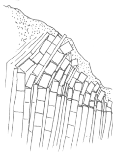
Şekil 2.9. Bloklu-bükülme tipi devrilme (Hoek ve Bray, 1977).
