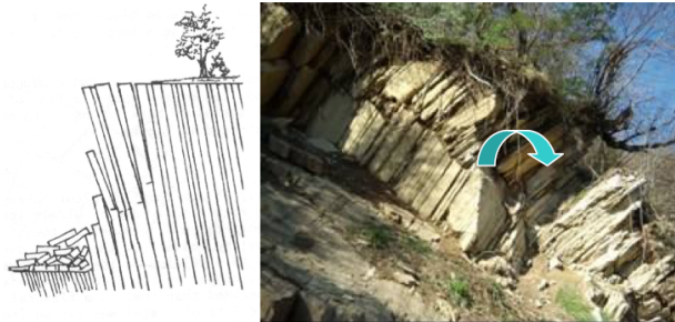
Şekil 2.7. Sert kaya şevlerinde meydana gelen bükülme devrilmesi (Hoek ve Bray, 1977) ve Kastamonu KB'sından bir örnek (Fotoğraf: R. Ulusay).
