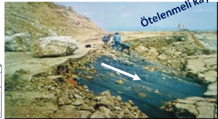
Şekil 2.16. Düzlemsel kaymanın blok diyagramı ve bir açık işletmede düzlemsel kayma (Fotoğraf: R. Ulusay).
