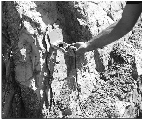
Şekil 2.27. Bir süreksizlik düzleminin yöneliminin pusula ile ölçümü.
