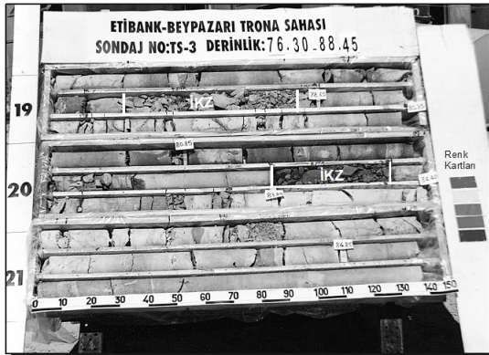
Şekil 3.8. Jeoteknik amaçlı bir sondaja ait karotlardan bir görünüm ve ilerleme aralığı dikkate alınmaksızın, ayrı ayrı değerlendirilmesi gereken ileri derecede kırıklı zonlar (IKZ).
