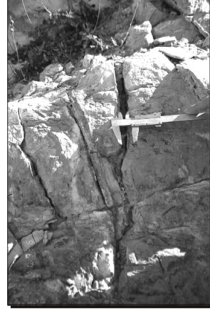
Şekil 2.20. Yumuşak dolgulu bir süreksizlik yüzeyinde mikrometre ile açıklık ölçümü.
