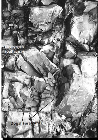
Şekil 3.5. Doğal süreksizlikler ve patlatma sonucu oluşmuş kırıklar.
