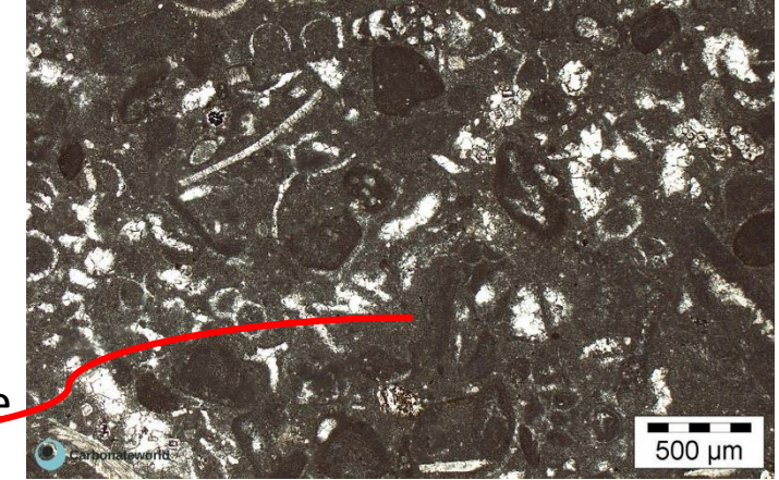
Mikritik (taneler mikroskopta ayırt edilemeyecek kadar küçük) fosilli kireçtaşı
