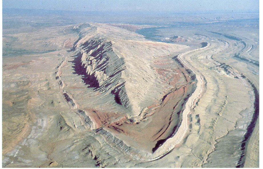
Şekil X.17. Çift dalımlı antiklinalin havadan görünümü
